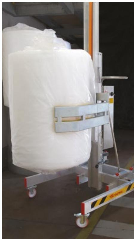
**HW.BIG con HW.PI, pinza di presa idraulica per sollevamento bobine.**
