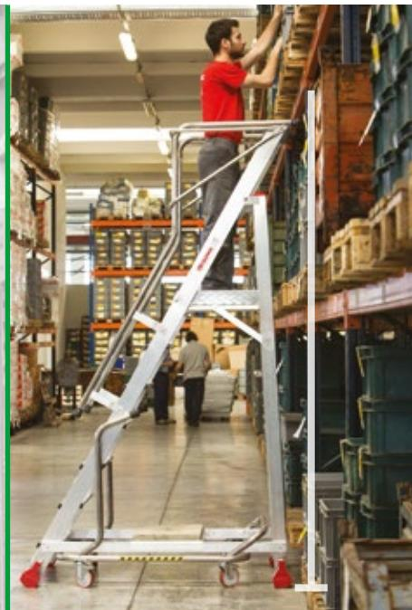
Parte posteriore verticale. Salita super confortevole, con inclinazione a 60°.
