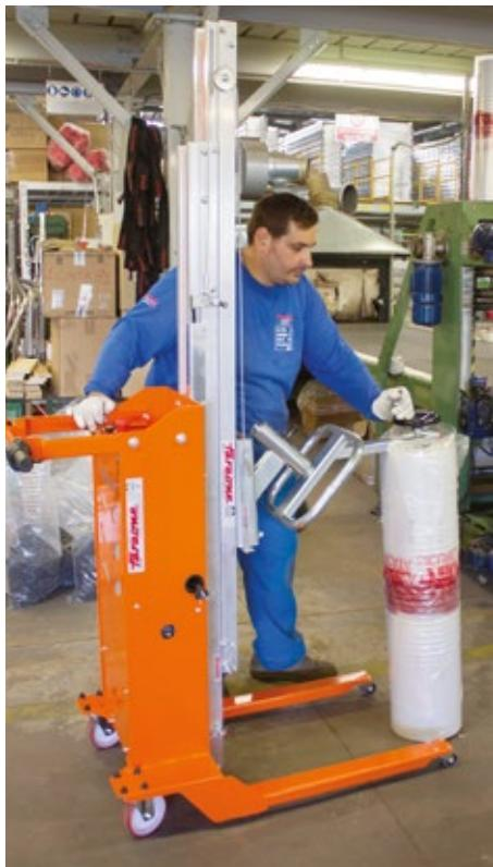
**HW.I BIG con HW.HW.2, braccio con sistema di blocco del tubo e rotazione per il prelievo di bobine.**
