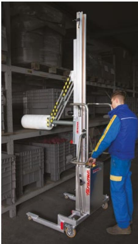
**HW.I con HW.HW.2, braccio con sistema di blocco del tubo e rotazione per il prelievo di bobine.**
