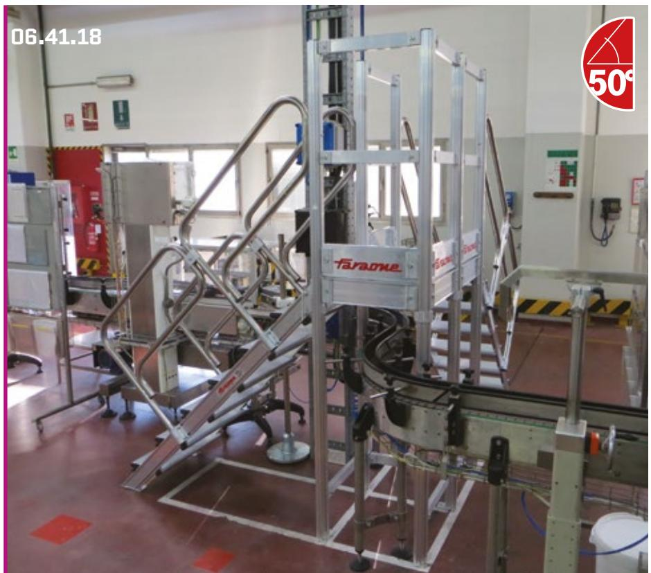
Scala con accesso laterale per oltrepassare la linea di produzione.
