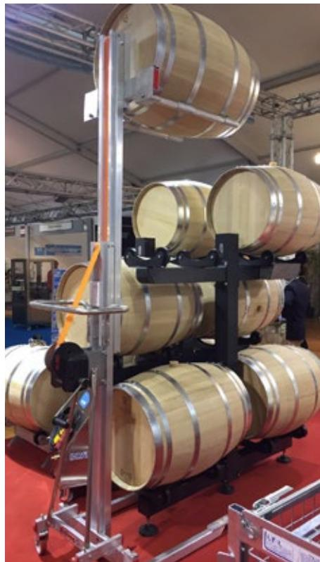
**HW 270 S con HW.FR, Forche regolabili per prelievo e posizionamento barriques.**
