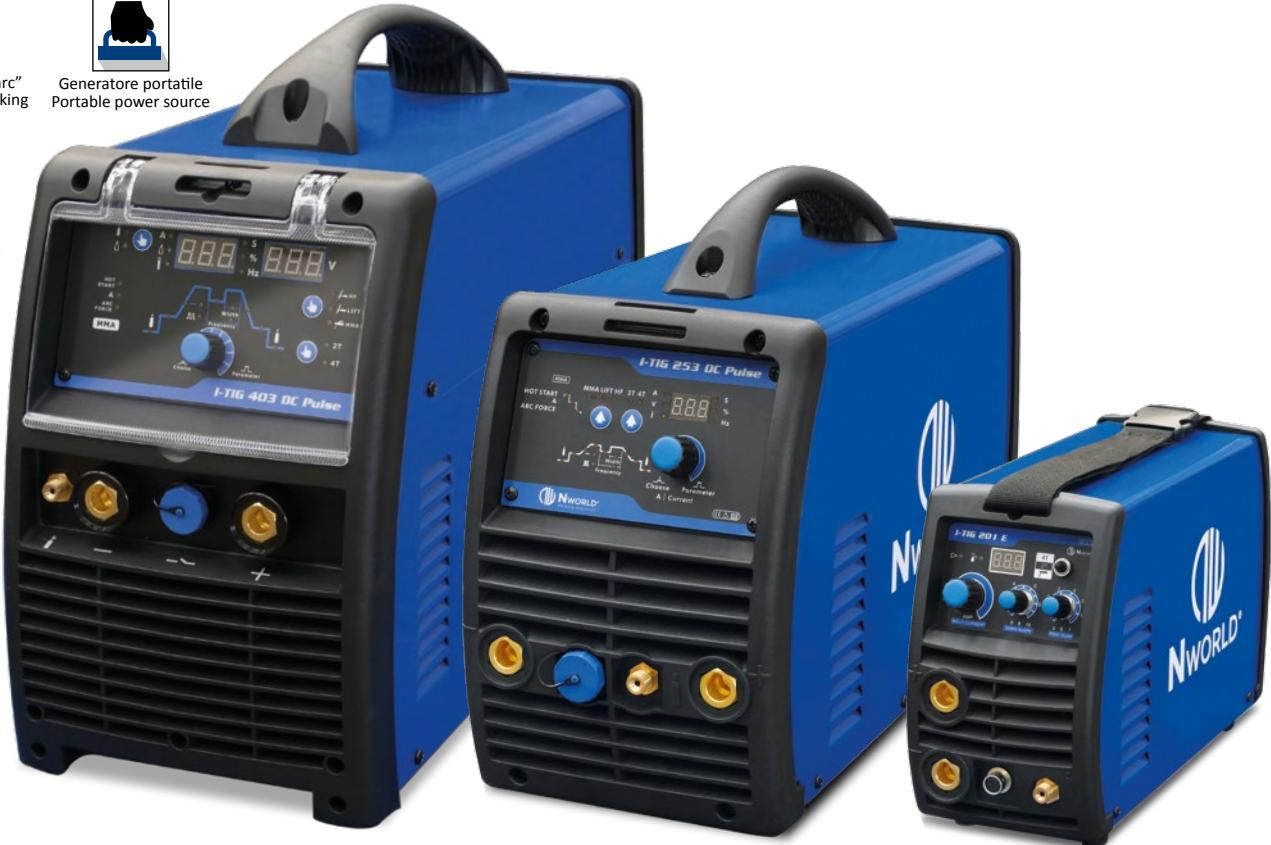
La tecnologia Inverter di I-TIG conferisce a queste saldatrici professionalità e qualità di saldatura. Le principali caratteristiche sono: compattezza e affidabilità, selettori funzioni (elettrodo 2T, 4T, puntatura e ripristino), comando a distanza, rampa di salita e discesa, regolazione frequenza di pulsazione, regolazione tempo post-gas, regolazione corrente di base, abilitazione HF o LIFT, Voltmetro e Ampèremetro digitali, progettato e costruito secondo la normativa EN 60974/1 - EN 60974 -10.
