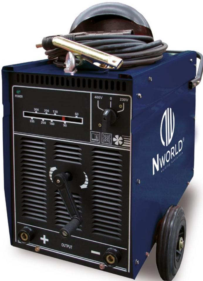
Saldatrici trifasi a corrente continua. Regolazione della corrente di saldatura tramite derivatore magnetico.
