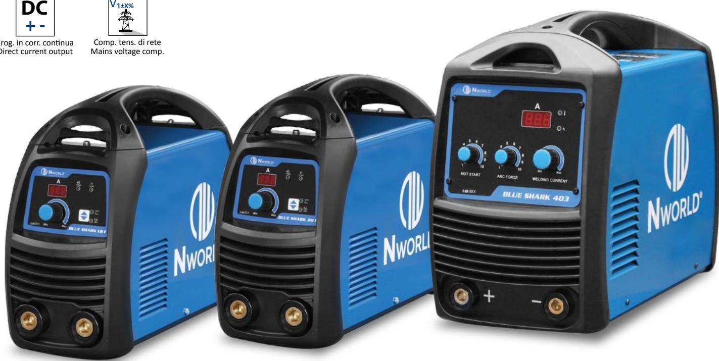
La serie Blue Shark è una gamma di generatori ad inverter progettata prevalentemente per la saldatura ad elettrodo. Le principali caratteristiche sono: alta resistenza ed affidabilità, saldatura di ogni tipo di elettrodo (alluminio e celluloso), arc-force, saldatura TIG con lift start, comando a distanza, progettato e costruito secondo la norma EN 60974/1 - EN 60974-10.
