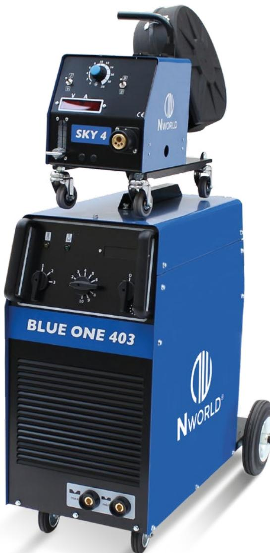
Gli impianti Blue One sono indicati per la saldatura semiautomatica con fili pieni e animati, di acciaio, acciaio inox, alluminio e rame. La struttura si presenta ridotta nelle sue dimensioni, pur mantenendo l'alta professionalità delle prestazioni. La tensione di saldatura viene regolata con commutatori a scatti posti sull'impianto, mentre gli altri comandi sono sull'alimentatore.
