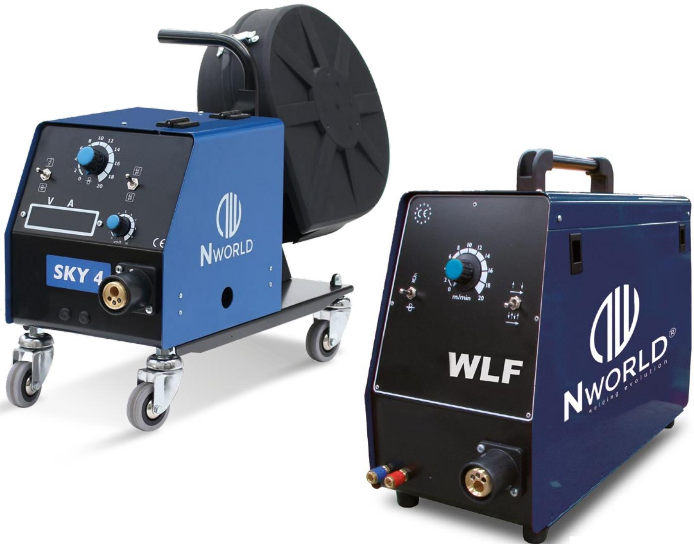
La Serie Sky 4S/WLF 4S è stata realizzata per essere applicata ai generatori con la regolazione a scatti della tensione di saldatura, come i nostri BLUE ONE. Si presentano completi di: regolazione velocità filo, kit 2/4 tempi, prova gas, prova filo; a richiesta kit digitale V+A, flussimetro e tachimetrica. Il filo è spinto da un sistema trainante a 4 rulli.
